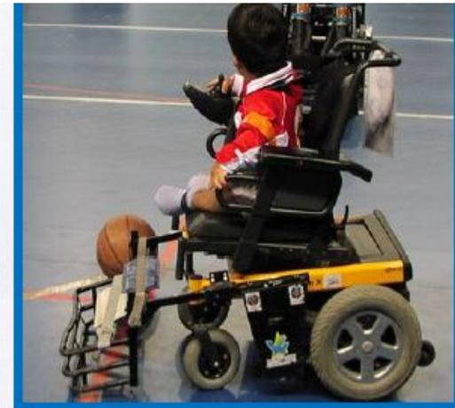
Les exigences réglementaires sont établies sur la base d'un fauteuil roulant occupé dont les dimensions d'encombrement sont de 0,75 m x 1,25 m.
